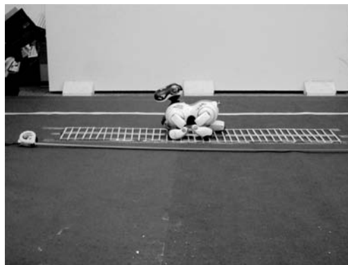
图 6 机器人在不平地面上的行走实验
